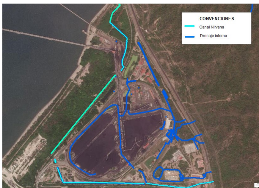
Figura 1-3 Drenaje interno de las instalaciones de Puerto Drummond
